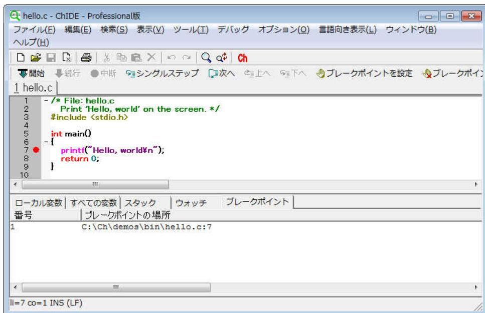
図 12: ブレークポイントの設定
