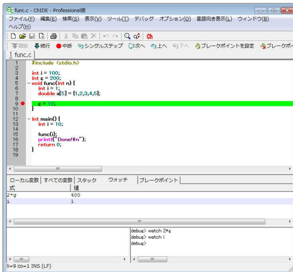
図 21: デバッグコマンドウィンドウ内でウォッチ式と変数を設定し、その値をデバッグウィンドウ内に表示
