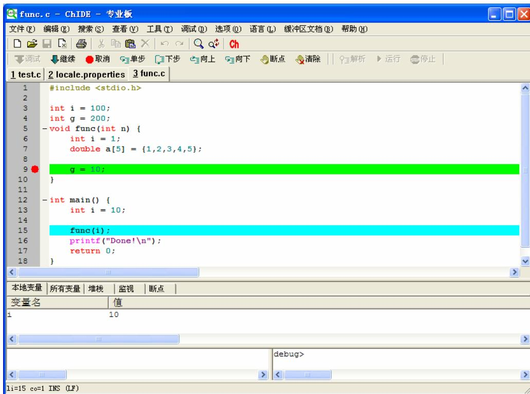
图 23 显示调用函数中的本地变量的名称和值
