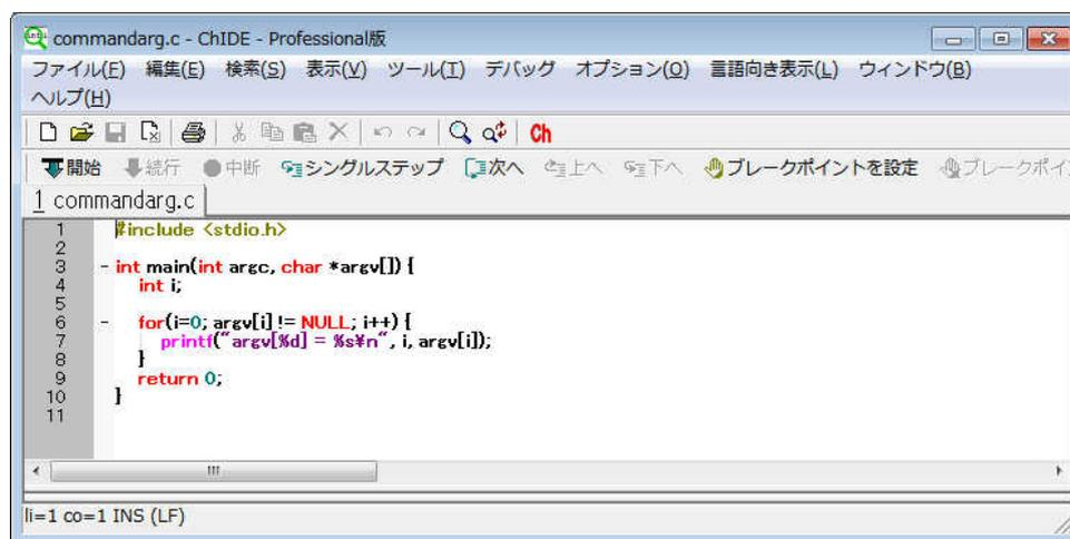
図 20: コマンドライン引数を扱うプログラム
