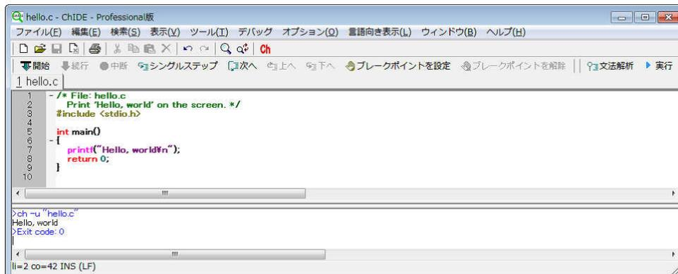
図 6: ChIDE 上の編集ウィンドウ内のプログラムの実行とその出力
