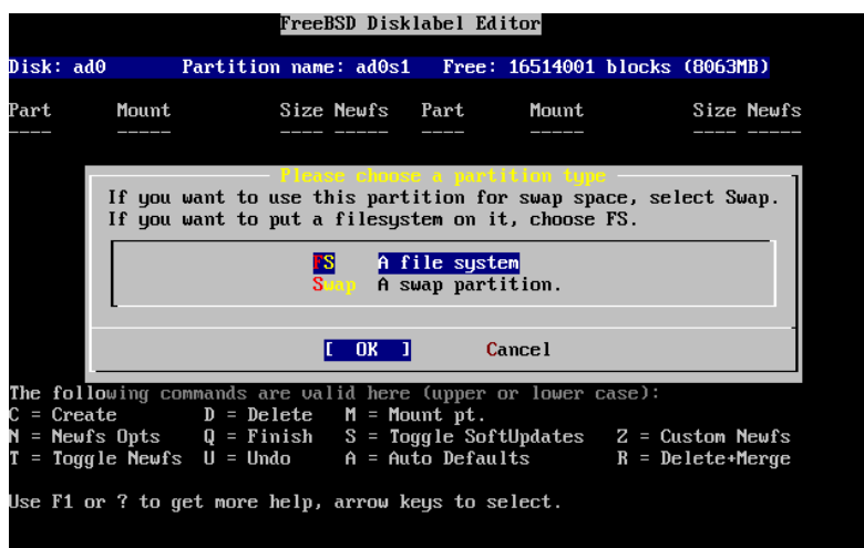
Rysunek 2-20. Wybór typu głównej partycji
