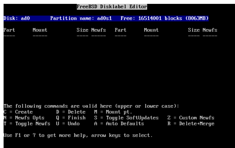
圖形2-18. Sysinstall 的Disklabel 編輯器
