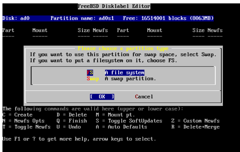
Ábra 2-23. A gyökérpartíció típusának kiválasztása
