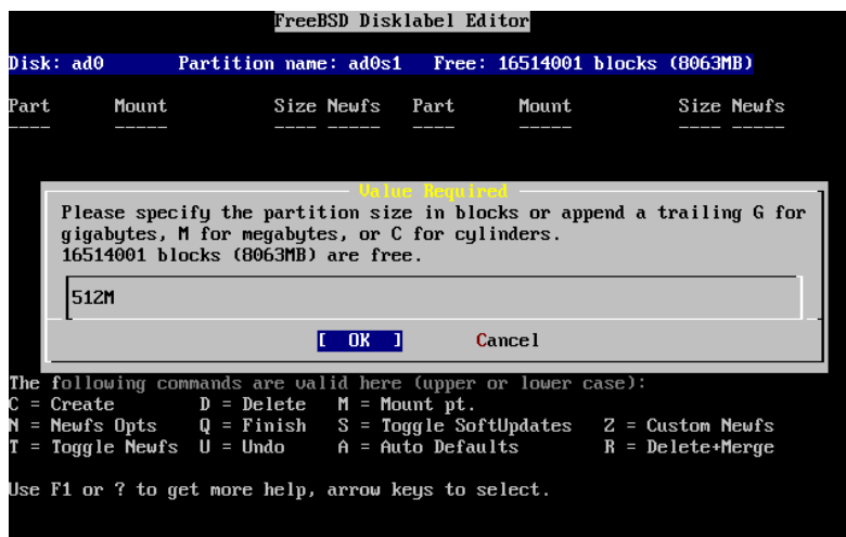
Ábra 2-22. A gyökérpartíció méretének szerkesztése
