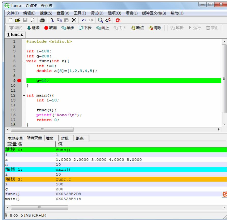
图 25 显示所有堆栈中的所有变量的名称和值
