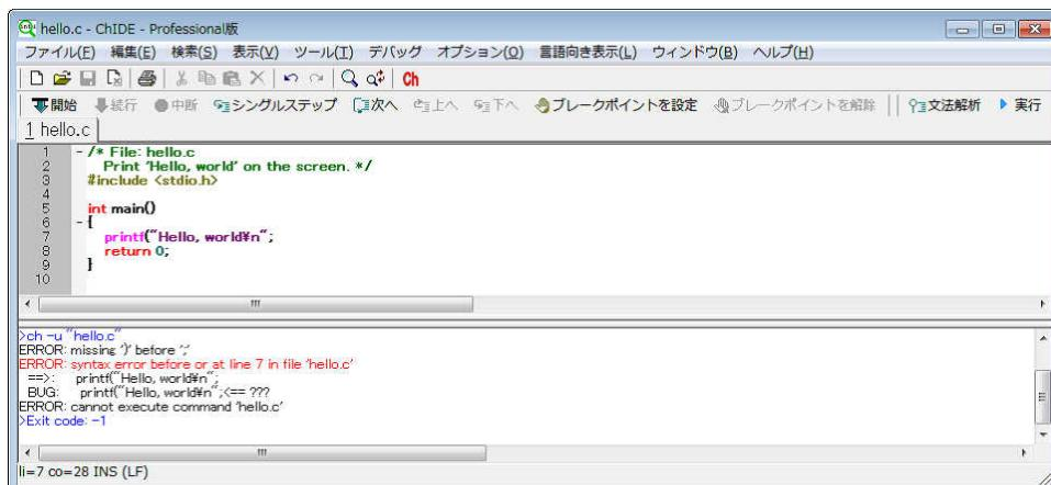
図 7: プログラム hello.c の実行結果の出力におけるエラー行
