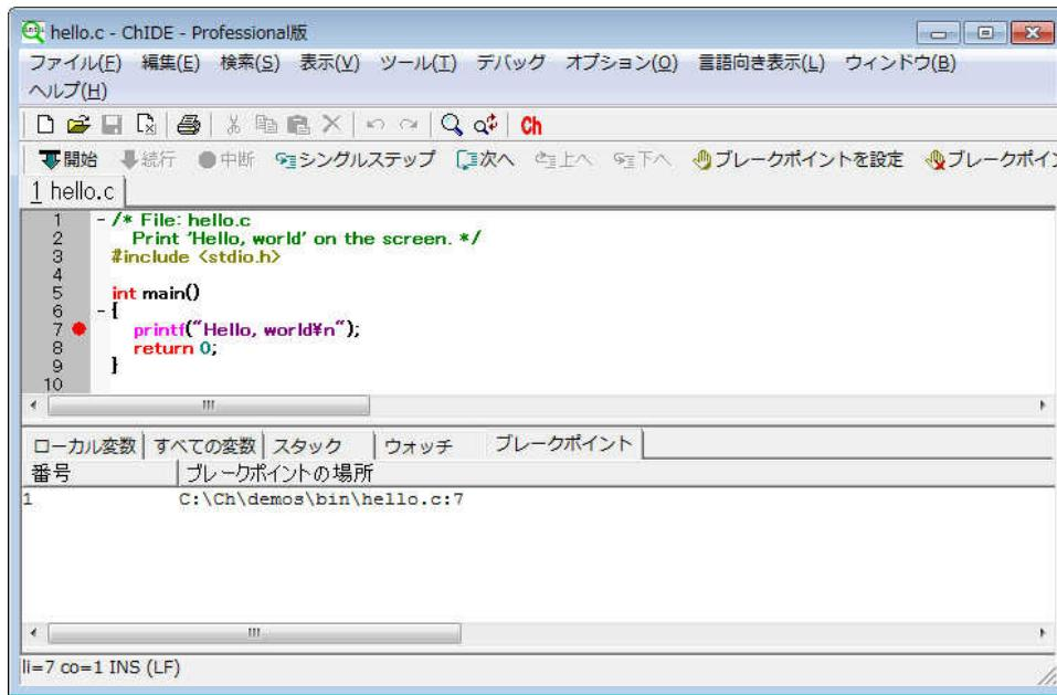
図 12: ブレークポイントの設定
