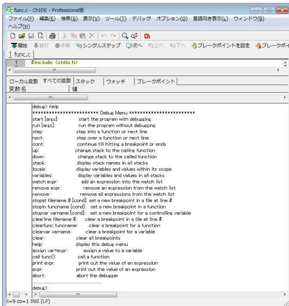
図 18: デバッグコマンドウィンドウ上のデバッグコマンド
