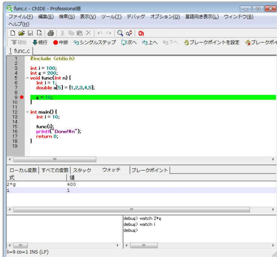
図 21: デバッグコマンドウィンドウ内でウォッチ式と変数を設定し、その値をデバッグウィンドウ内に表示
