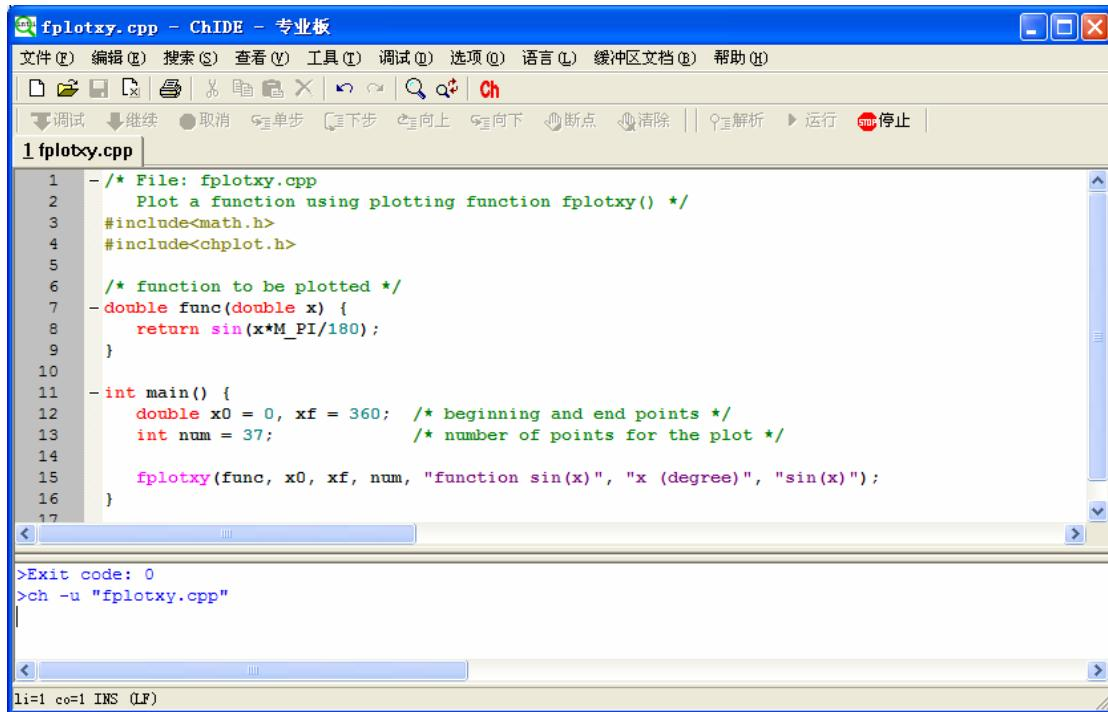
图 12 调用绘图函数 `fplotxy()` 程序
