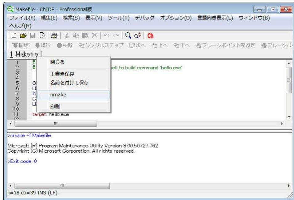
図 27: C/C++ プログラムをコンパイルするための make ファイルの使用
