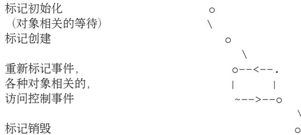
使用标记初始化入口函数，策略可以以一种统一的、与对象使用环境无关的方式设置标记的初始值。分配给一个策略的缺省slot值为0，这样不使用标记的策略可能并不需要执行专门的初始化操作。
