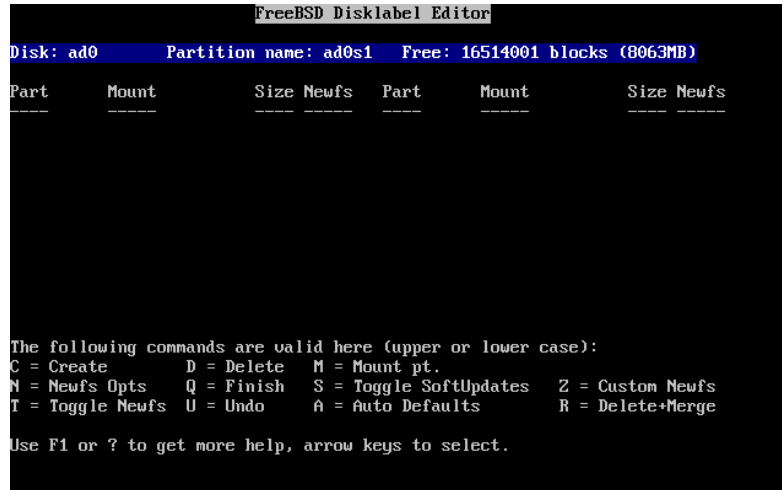
Ábra 2-19. A sysinstall Disklabel partíciószerkesztője
