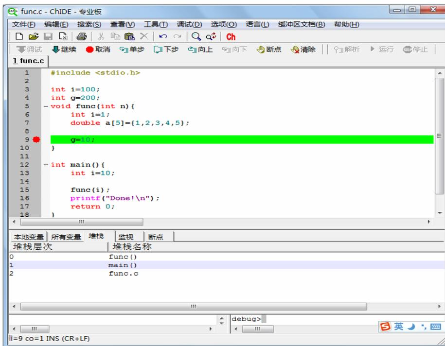
图 24 显示程序执行过程中的函数堆栈级别
