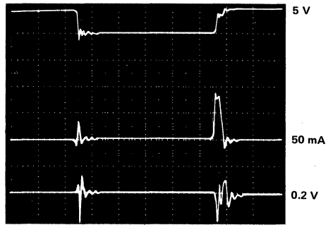
h) SN74AS1000 load: C_L = 50 \text{ pF}
