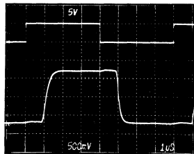
RL = 1MΩ, CL = 500pF, V1 = -500mV, V16 = +500mV
