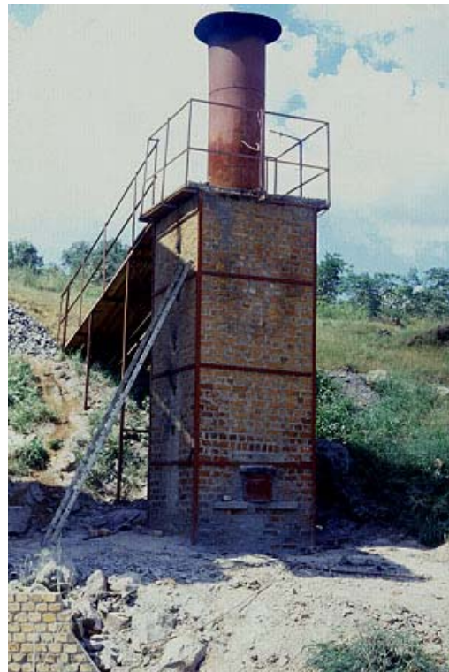
Figura 2: Producción de cal a pequeña escala en Chegutu, Zimbabwe. Foto: Practical Action / Kelvin Mason.
