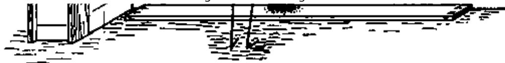
**Fig. 1 PREPARATION OF SCREEDS**
