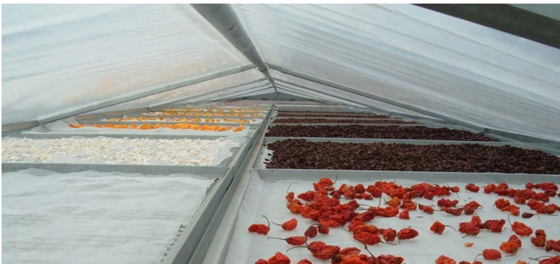
Picha 8: Inavyoonekana ndani ya kikaushio cha Sola ya chini kwa chini. Picha na: Tony Swetman.
