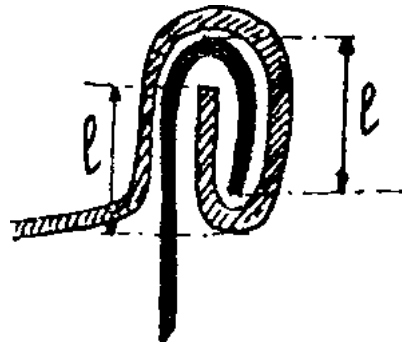
Figure 86. Jonction étanche, par sertissage, d'un couvercle métallique sur une boîte de
