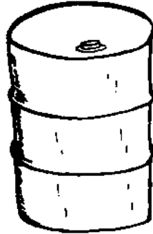
Figure III.18 Fût métallique servant pour le stockage des grains en vrac
