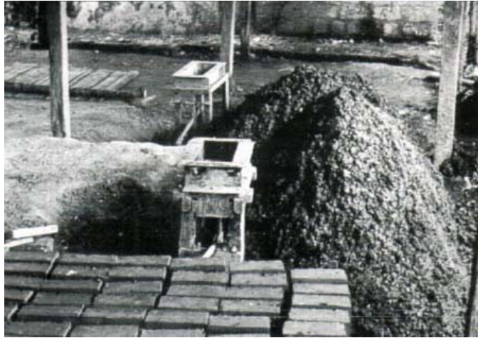
Producción a pequeña escala de bloques de ceniza volcánica y cal en Indonesia.
