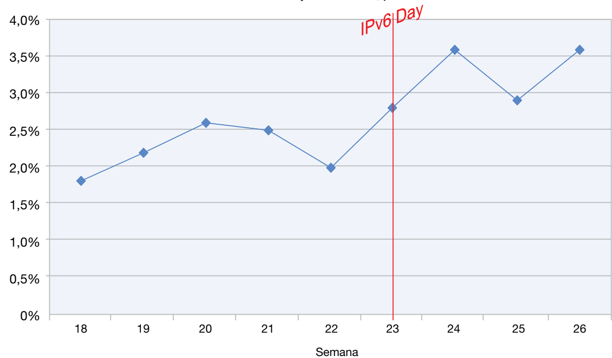
Figura 18: Porcentagem de Domínios que Oferecem Hosts IPv6 - maio a junho de 2012, por semana
