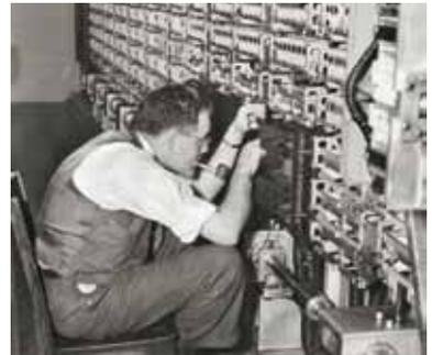
**As primeiras máquinas tabuladoras dependiam de um dispositivo mecânico para ligar e desligar os circuitos.**
