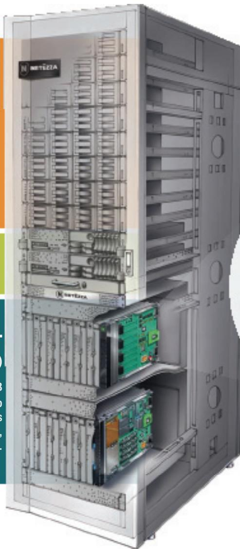
IBM Netezza 1000 utiliza Field Programmable Gate Arrays (o FPGAs) que se han programado específicamente para gestionar grandes volúmenes de datos con una gran eficiencia. Estos FPGAs filtran datos irrelevantes tan pronto salen del disco. Esto elimina cuellos de botella de E/S y hace que los componentes situados a continuación del proceso, tales como la CPU, la memoria y la red, no tengan que procesar datos innecesarios, creando un efecto turbo considerable en el rendimiento del sistema.
