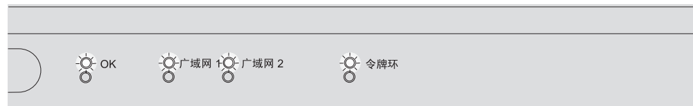
图 1-13. 121、123 和 12T 型设备在端口面反面的指示灯
