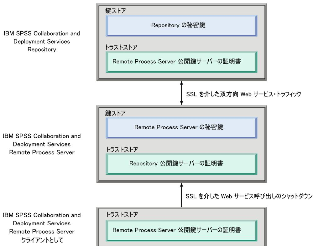
図1. IBM SPSS Collaboration and Deployment Services Remote Process Server の SSL アーキテクチャー
