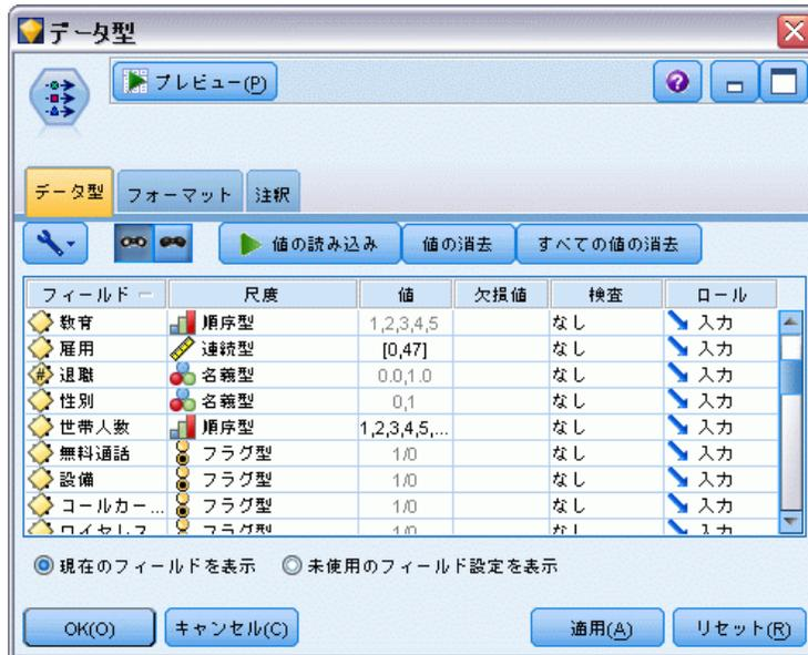
ヒント：類似した値（0/1 など）を持つ複数のフィールドに対しプロパティを変更するには、[値] 列のヘッダをクリックしてフィールドを列によってソートし、Shift キーを使用して、変更するフィールドをすべて選択します。その後、選択したフィールドの上で右クリックをすると、選択したフィールドの測定レベルまたは属性を変更することができます。
