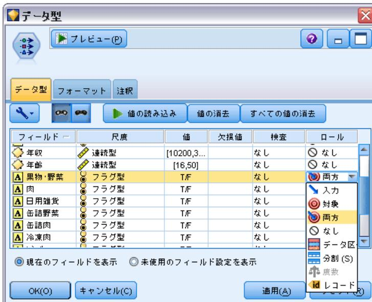
モデリング用フィールドを指定したら、Apriori ノードをデータ型ノードに接続して、Apriori ノードを編集し、[フラグは真の値のみ] オプションを選択して、Apriori ノードを実行します。結果は、マネージャ ウィンドウの右上の [モデル] タブにモデルとして表示されます。このモデルには、アソシエーション ルールが含まれており、コンテキスト メニューの [ブラウズ] を選択して表示することができます。
