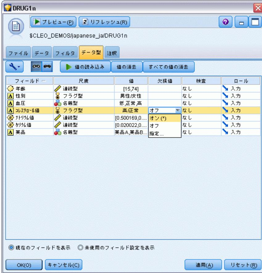
[データ] タブをクリックして、フィールドのストレージを変更します。ストレージは尺度とは異なり、またデータ フィールドの測定レベル（使用タイプ）とも異なることに注意してください。[データ型] タブでは、データ中のフィールドのデータ型を確認することができます。また、[値の読み込み] を選択し、[値] 列の選択内容に基づいて、各フィールドの実際の値を表示することもできます。この過程は、インスタンス化として知られています。
