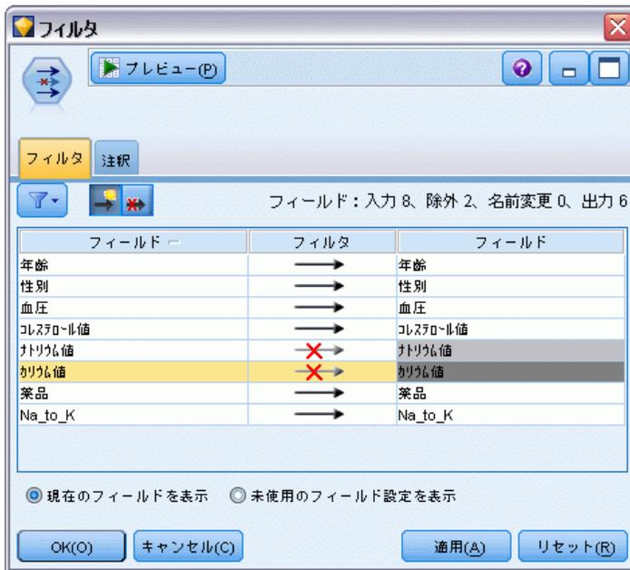
[フィルタ] タブで、[Na] および [K] の隣にある矢印をクリックします。フィールドが除外されることを表す赤い X が矢印上に表示されます。
