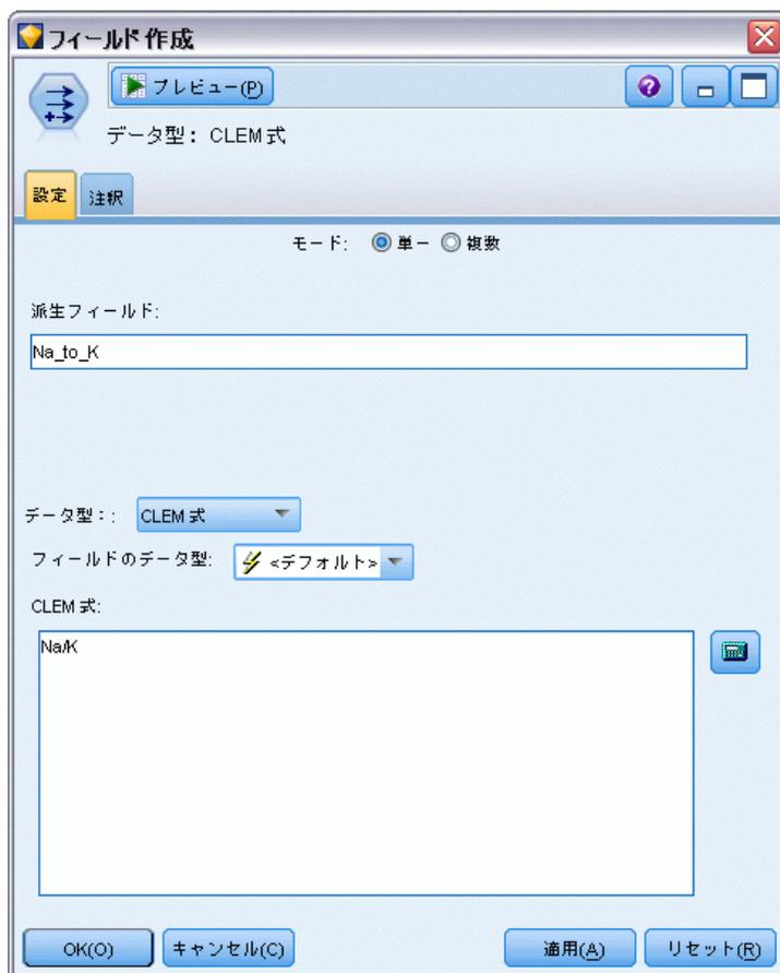
新規フィールドの名前に、「ナトリウム値/カリウム値」を指定します。新しいフィールドの値は、ナトリウム値をカリウム値で除算して得られるので、式に「ナトリウム値/カリウム値」と入力します。フィールドの右にあるアイコンをクリックして式を作成することもできます。アイコンをクリックすると、Clem 式ビルダーが表示されます。これを利用すれば、すでに存在している関数、オペランド、およびフィールドと値を使って、対話的に式を作成することができます。
