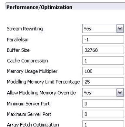
**ストリームのリライト：**(`stream_rewriting_enabled`) サーバーがストリームをリライトすることで、ストリームを最適化できるようにします。たとえば、サーバーは、データセットのサイズをできるだけ小さくするために、入力ノードの近くにデータ削減の操作をプッシュできる場合があります。このオプションの無効化は通常、最適化がエラーや予期しない結果の原因になる場合にだけ、推奨されます。この設定により、対応するクライアントの最適化設定が上書きされます。
