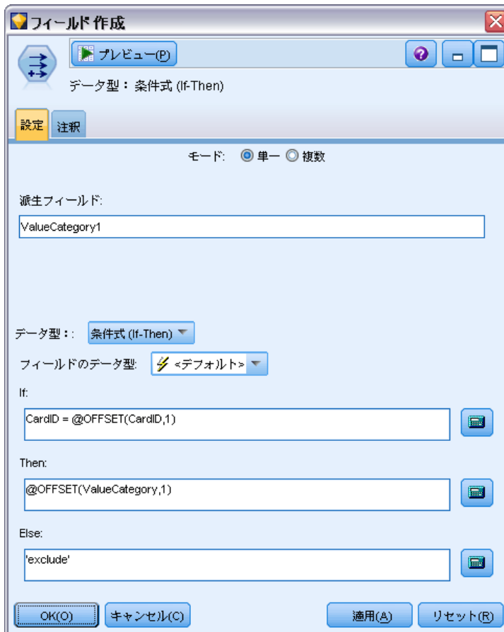
図 7-3 あるフィールドの値をその前のフィールドと比較する条件式
