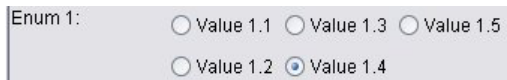
Figura 76. Panel con grupo de botones de radio en el orden de columnas
