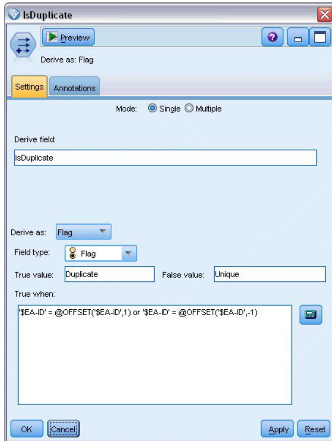
Figura 14. Impostazione della condizione nel nodo Ricava
