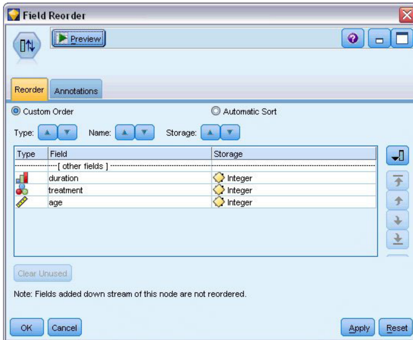
图 287. 对字段进行重新排序以使其按预期输入到模型中
