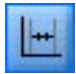
Figura 52. Icono de división utilizado para expandir la barra de herramientas con opciones para dividir en tramos
