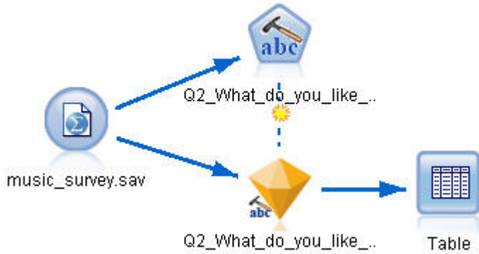
Figura 3. Esempio di flusso: nodo file delle statistiche con il nugget del modello di concetto di estrazione testo
