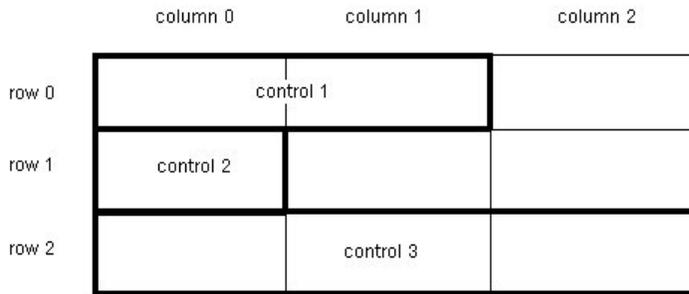
图 77. 使用单元格的控件布局示例
