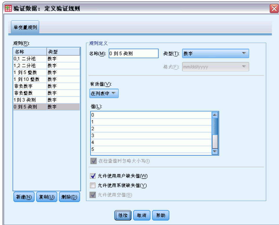
图片 7-21 “定义验证规则”对话框，“单变量规则”选项卡（定义了“0 to 5 Categorical”）
