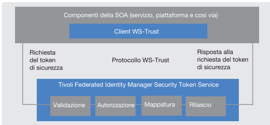
Figura 3.7 Propagazione dell'identità all'interno di una SOA realizzata utilizzando WS-Trust e IBM Tivoli Federated Identity Manager STS
