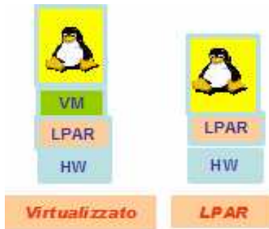
Figura 130 Modalità operative di Linux su mainframe
