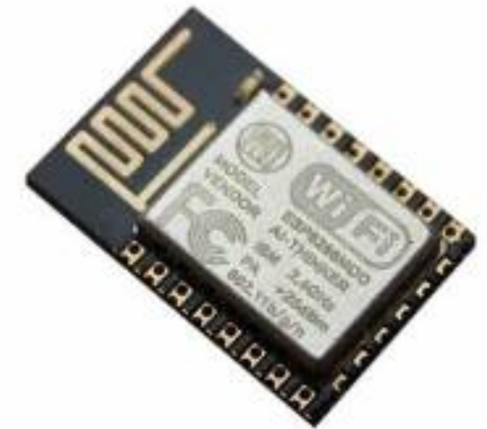
ESP12E – Coração do NodeMCU
