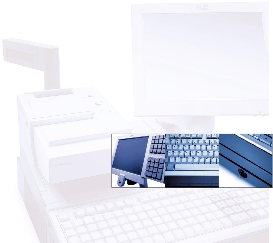
جهاز نقطة البيع / الخدمة (POS) جاهز للعمل. وقد تم اختبار التصميم الخاص به في معاملتنا لحماية الأجهزة الإلكترونية ضد مخاطر الأتربة والرطوبة وانسكاب الطعام. كما أن أدراج التقديمة مصممة خصيصاً لتحمل الصدمات المترسبة الناتجة عن الفتح والإغلاق المفاجئ. كما أن الذاكرة التي لا تختفي بانقطاع التيار الكهربائي تساعد على الحفاظ على البيانات الهامة مثل اجماليات النظام، وبذلك لا يفقد أصحاب المتاجر بيانات البيع الهامة.
