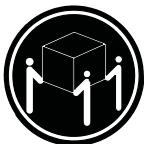
Este componente o unidad pesa entre 32 y 55 kg (70,5 y 121,2 lb). Para levantar este componente o unidad de forma segura se necesitan tres personas. (C010)
