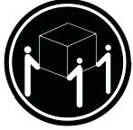
Данный предмет или узел весит от 32 до 55 кг. Поднимать его следует втроем. (C010)
