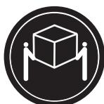
Este componente o unidad pesa entre 18 y 32 kg (39,7 and 70,5 lb). Para levantar este componente o unidad de forma segura se necesitan dos personas. (C009)
