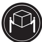
Waga tej części lub jednostki wynosi od 18 do 32 kg (od 39,7 do 70,5 funta). Do bezpiecznego przeniesienia tej części lub jednostki potrzebne są dwie osoby. (C009)
