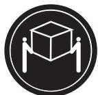
O peso deste componente ou unidade situa-se entre os 18 e os 32 kg (39,7 e 70,5 lb). São necessárias duas pessoas para mover este componente ou unidade em segurança. (C009)
