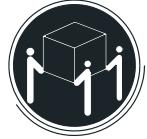
Hmotnost této součásti nebo jednotky se pohybuje mezi 32 a 55 kg. K bezpečné manipulaci jsou zapotřebí tři osoby. (C010)
