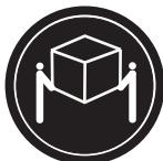
Данный предмет или узел весит от 18 до 32 кг. Поднимать его следует вдвоем. (C009)
