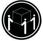
O peso deste componente ou unidade situa-se entre os 32 e os 55 kg (70,5 e 121,2 lb). São necessárias três pessoas para mover este componente ou unidade em segurança. (C010)
