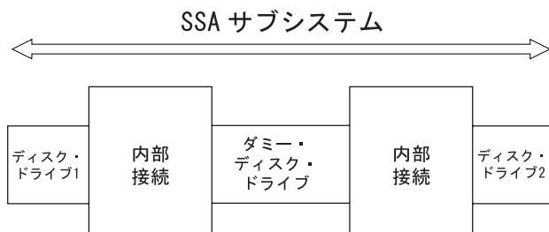
図 60. 1 つのサブシステム内の 5 つの部分のリンク
