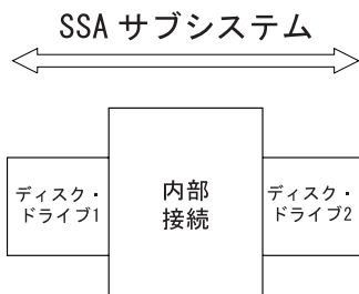
図 59. 1 つのサブシステム内の 3 つの部分のリンク
