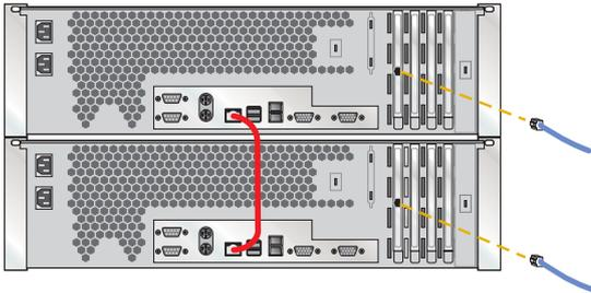
4. 根據您的特定硬體配置連接其他電纜線 (光纖纜線、乙太網路或 Gigabit 乙太網路)。請參閱硬體安裝手冊以取得特定指示。
