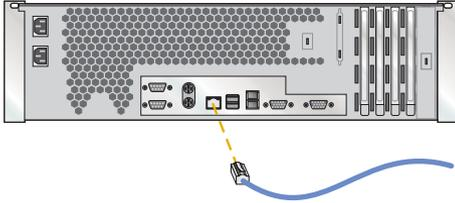
3. **僅適用機型 G26**：將乙太網路對絞電纜線兩端個別插接兩台引擎後方的乙太網路連接埠，以連接兩台引擎。將網路電纜線兩端個別插接到每一張乙太網路配接卡的連接埠及您的網路，以連接每一台引擎。請參閱硬體安裝手冊以取得網路連線的特定資訊。
