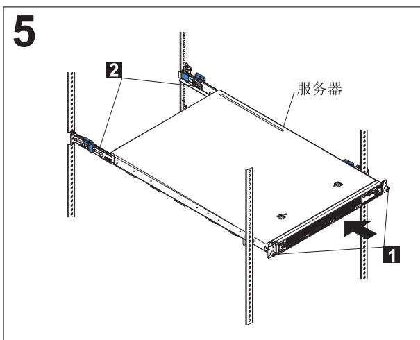
在滑动导轨上对齐服务器，然后将服务器完全推入机架机柜。
