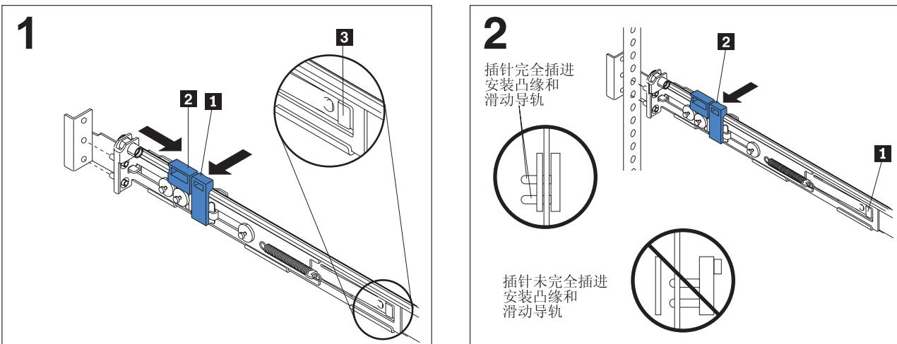
按住前导轨锁定托架上的调整片 **1** 和调整片 **2**，然后将导轨锁定托架滑向滑轨后部，直至其卡入到位。
