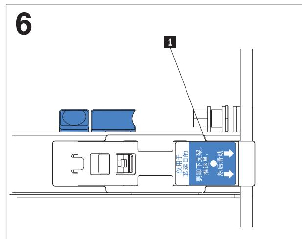
按住装运支架上标明的释放调整片 **1**，然后将装运支架从滑动导轨上滑脱。对其它装运支架重复此步骤。保存装运支架以供将来使用。
