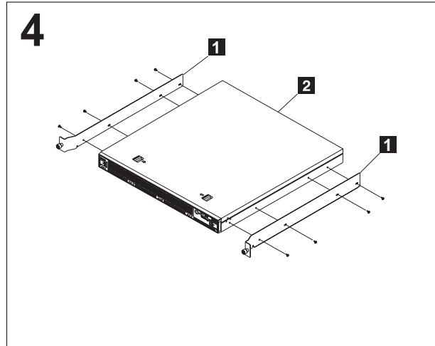
使用支架安装螺丝将侧支架 **1** 连接至服务器 **2**。
