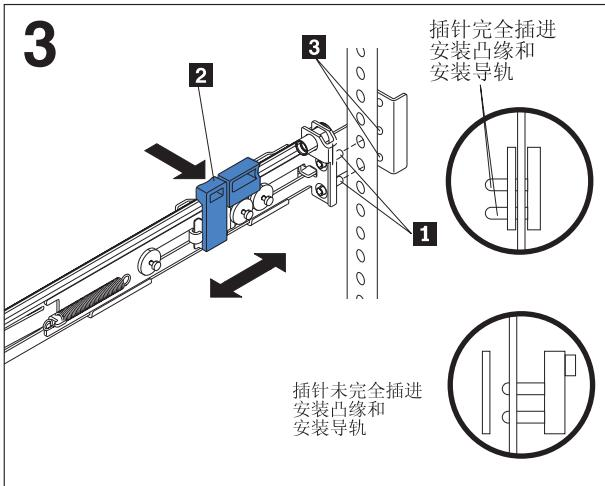
将前导轨锁定托架上的插针 **1** 与前安装凸缘对齐。如果调整了导轨长度，请将导轨锁定托架向后推至滑动导轨的后部，以将滑动导轨与安装凸缘 **3** 对齐。然后，按住调整片 **2** 以将滑动导轨的前部固定在前安装凸缘上。
