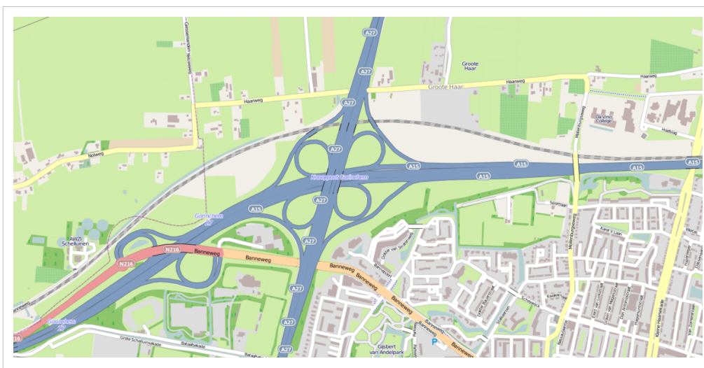
Het tracé van de Betuwelijn is zoveel mogelijk gebundeld met de A15. De bundeling is echter niet altijd even strak . Aan de westzijde van Gorinchem (links op de kaart) is de bundeling duidelijk losser om ruimte te maken voor een knooppunt en aansluiting.
