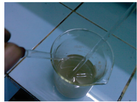
Quấy thật đều và đổ 1 ít ra mặt kính đồng hồ, nhỏ vài giọt đường vào để thử dung dịch đã ổn chưa.
