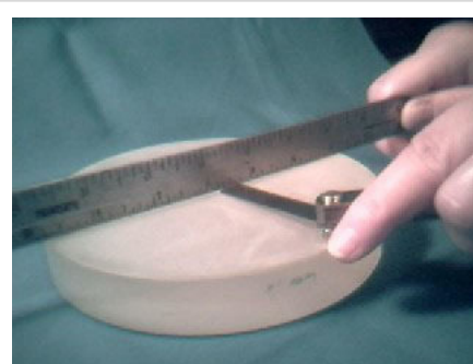
Đặt thước dọc theo đường kính gờng và đo độ sâu bằng các lá căn chuẩn tại tâm gờng
