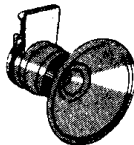
አይን አቅርብ ግጉሊያ eyepiece magnifier
