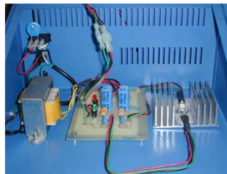
Figura 3.- Fuente de alimentación regulada +12VCD, +5VCD
