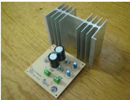
Figura 3.- Fuente de alimentación regulada +12VCD, +5VCD
