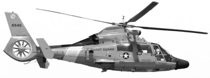
Figura 1.4. Helicóptero de los U.S. Coast Guard con Fenestron.
