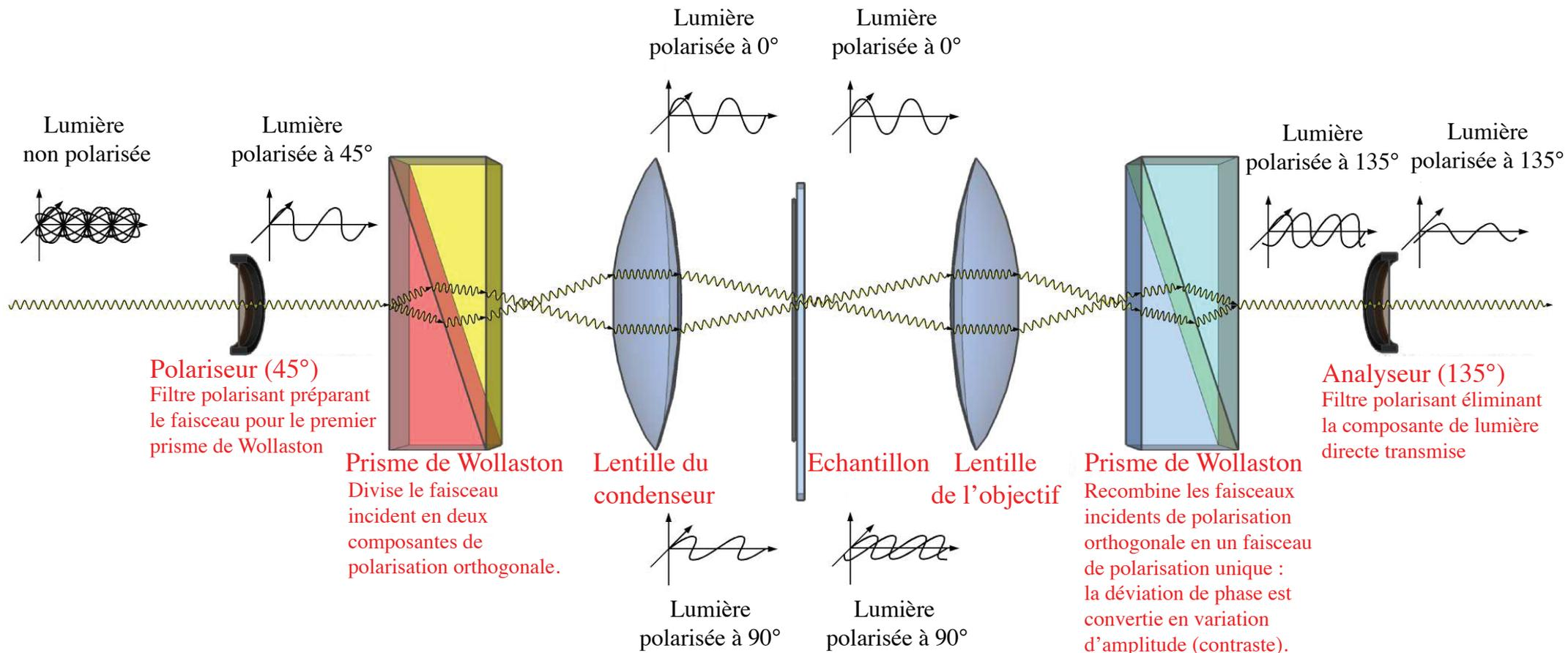
Déviaton de phase induite par l'échantillon, d'ampleur différente pour les deux faisceaux (selon la structure de l'échantillon).
