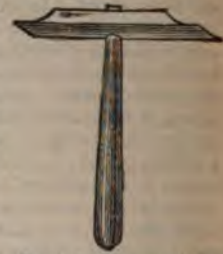
Фиг. 1. Молотокъ для колки смальты (итальян. Martellina).
