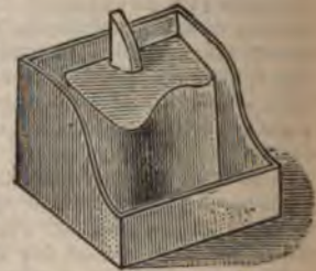
Фиг. 2. Рѣзецъ для колки смальты (итальян. Tagliope).
