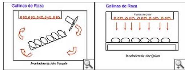
Fig 7 Ventilación forzada y estancada.
