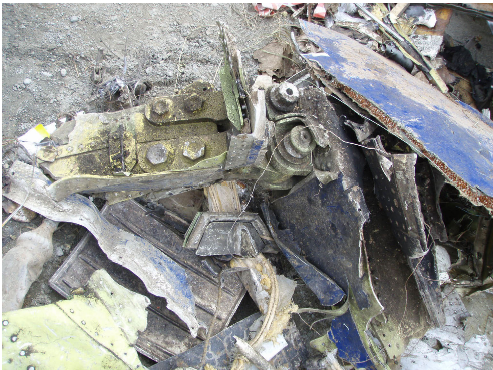
Место крепления правого полукрыла к центроплану
