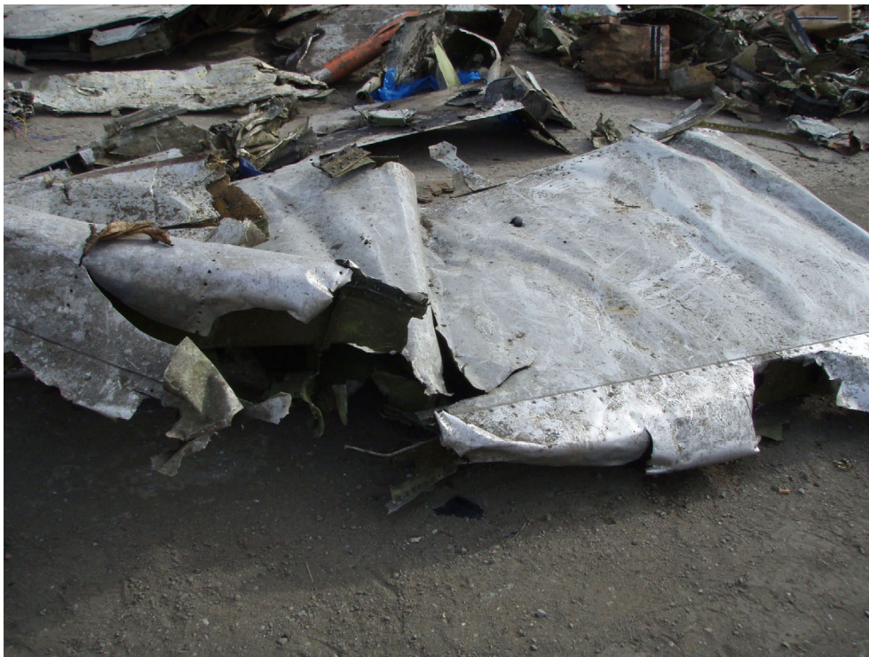
Внутренняя часть правой половины стабилизатора
