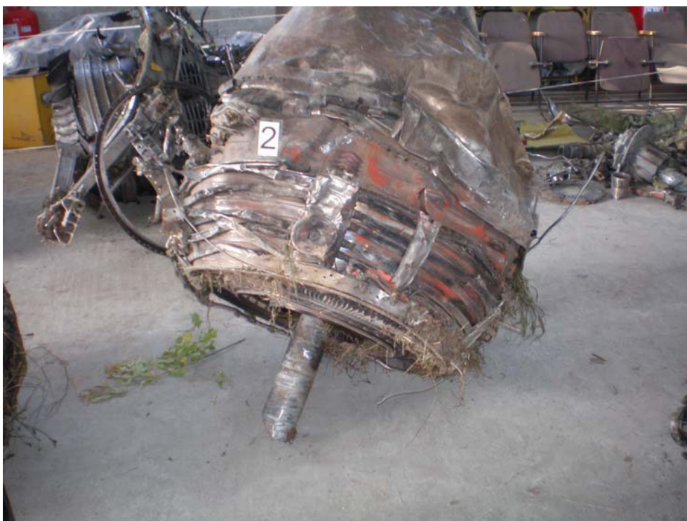
Турбина низкого давления с сопловым аппаратом правого двигателя
