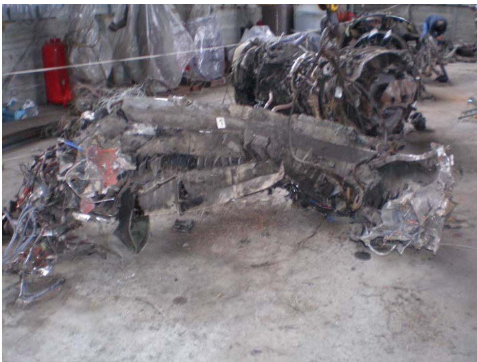
Корпус вентилятора левого двигателя
