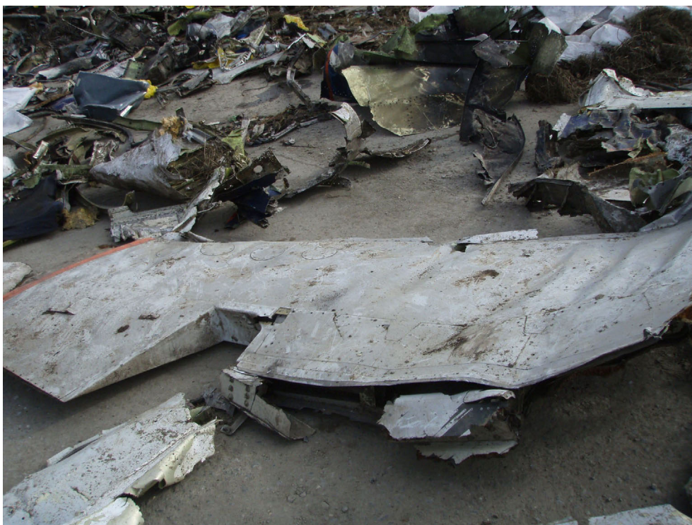
Внешняя часть правой половины стабилизатора
