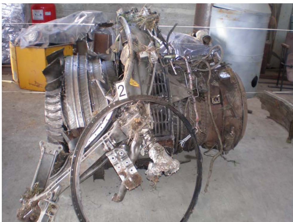
Вентилятор с компрессором правого двигателя
